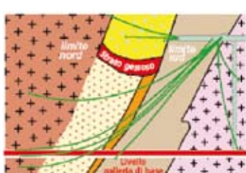
Galleria di base del San Gottardo - sezione geologica longitudinale Fonte: Alptransit S.Gottardo SA, 2005
