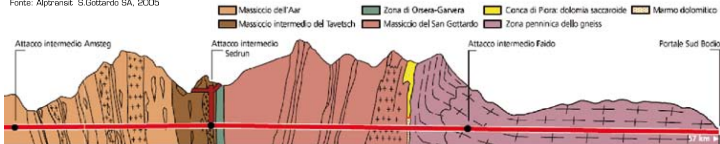
Galleria di base del San Gottardo - sezione geologica longitudinale Fonte: Alptransit S.Gottardo SA, 2005
